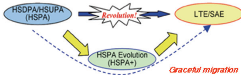
● 図59 3GPPが想定しているHSPA+をベースにした3G LTEの標準化
